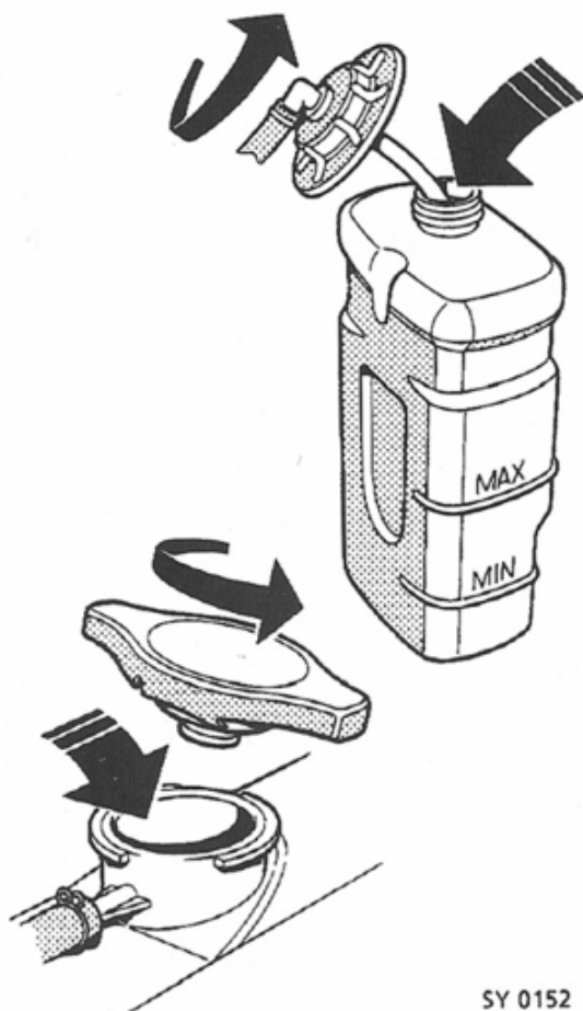
Vyrovňovací nádržka chladicího systému a víčko plnicího otvoru - všechny modely se zážehovými motory, kromě modelu 620ti
